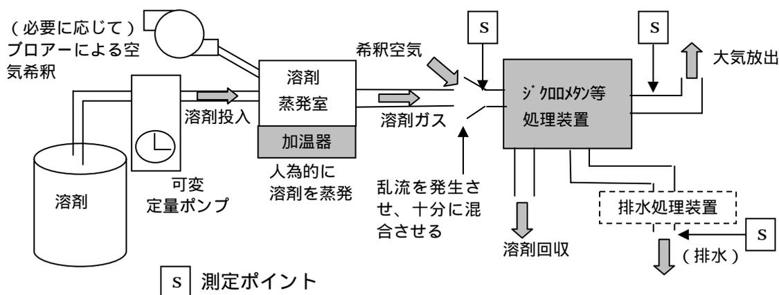
図 2 試験装置イメージ（例示）
