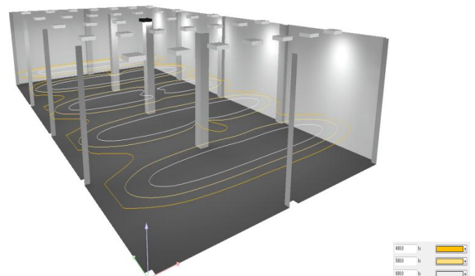
図4 計算結果一作業面の照度分布（例）
