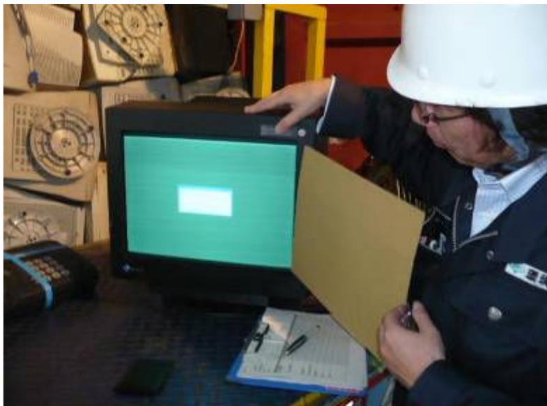
ベトナム向けに中古利用目的で輸出申告された CRT モニターに対する通電確認の様子
