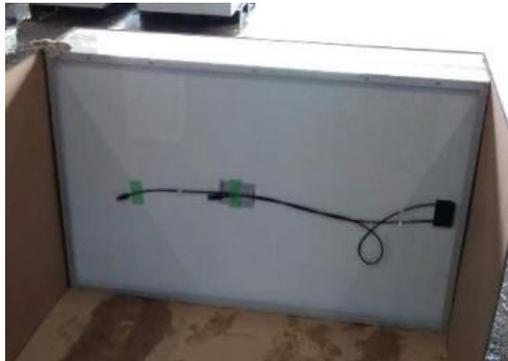
ジャンクションボックスが正常に設置され、断線を防止するためにケーブルを固定している。
