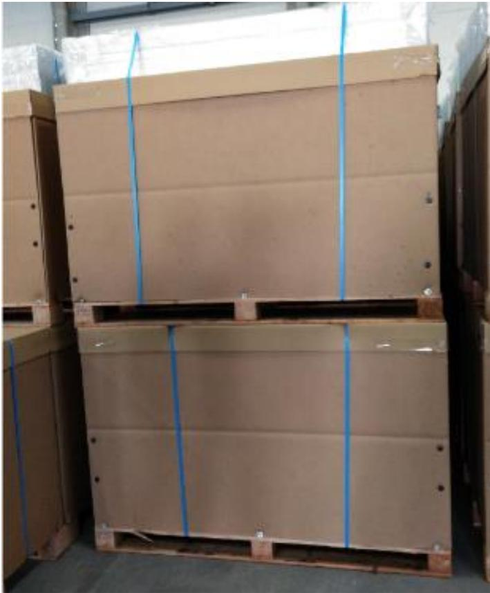
荷崩れによる破損を防ぐために十分な結束、保護がされている。
