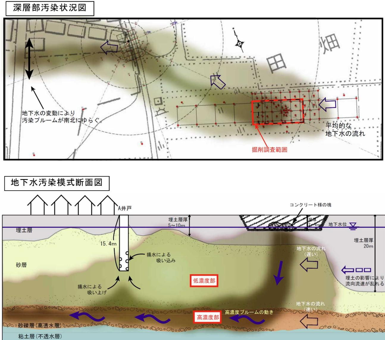
図 2-1 A 井戸周辺の汚染メカニズム
