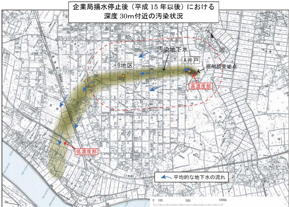
図 2-2 AB トラックを含む広域範囲における深層部地下水汚染状況図
