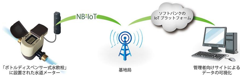
図 16 水道メーター自動検針の実証実験 出所) 愛知時計電機
