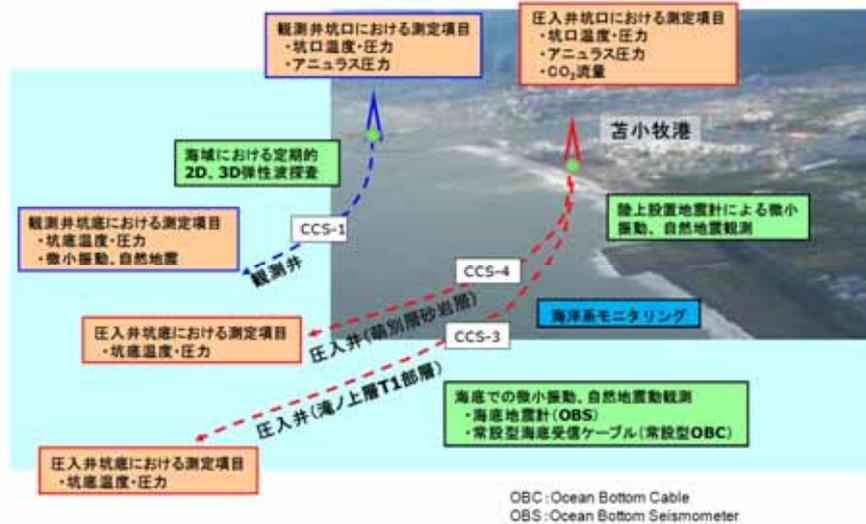
図 2.2-19 圧入中のモニタリング概念図
