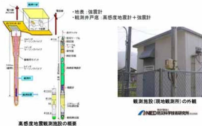
(防災科学研究所の高感度地震観測網 Hi-net : 防災科学技術研究所が運営している地震動の観測システムで、全国に観測点を配置し、緊急地震速報の発信にも活用されている。)
