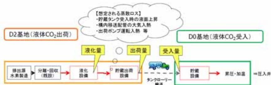
図 2.2-4 液体CO<sub>2</sub>の大規模輸送システム
