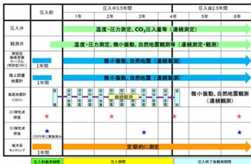
図 2.2-13 モニタリングスケジュールの概要
