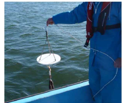
図 1.1 白色円板による透明度の測定の様子
