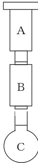
A 注射器 B 試料捕集管 C 全量フラスコ
