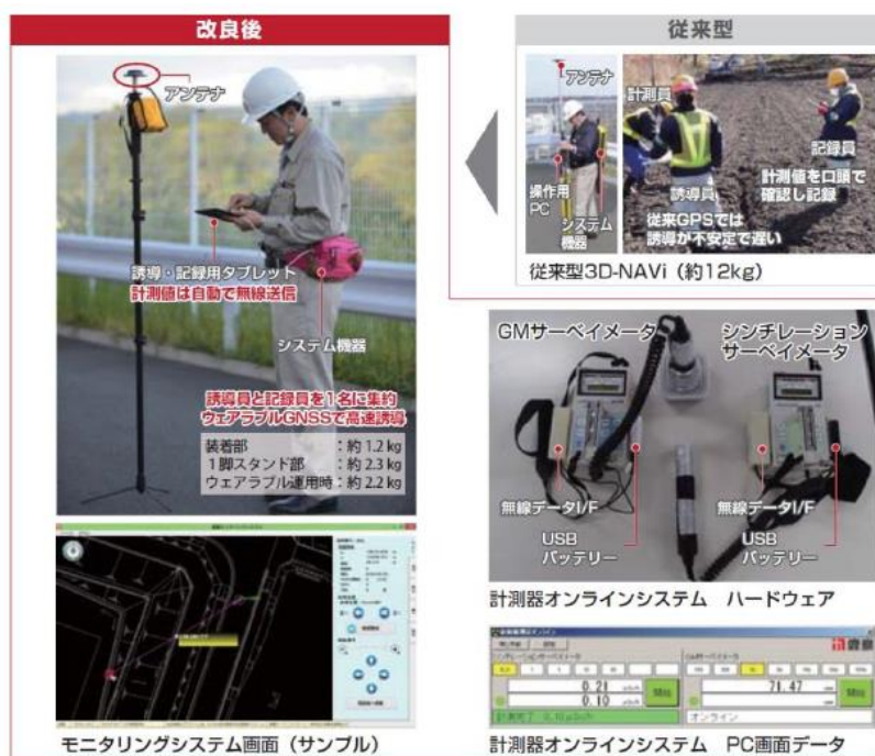
図 4-8 装着式位置確認装置による空間線量率測定システムの例
