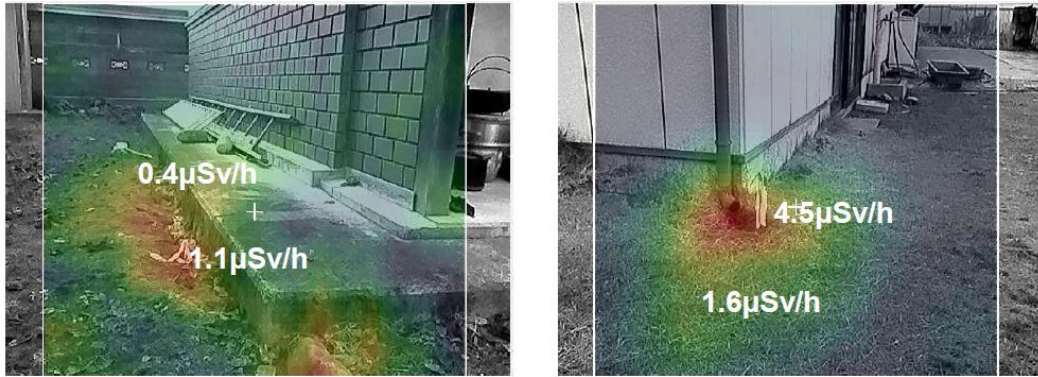
図 4-10 ガンマカメラの撮影例
