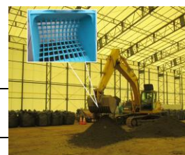
バックホウ（スケルトンバケット付） 大成建設(株)提供
