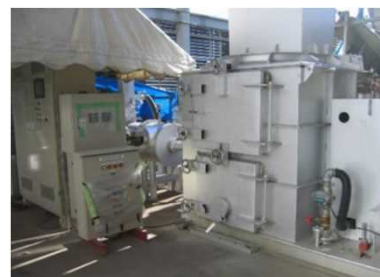
テスト機：乾溜ガス化燃焼装置MGB-150SE型 スターリングエンジン付
