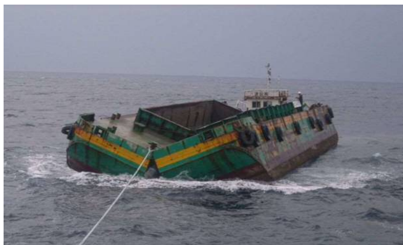
写真1 土運船（全開式）によるしゅんせつ土砂の排出状況
