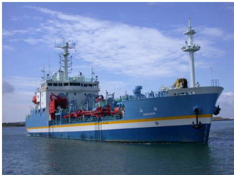
大型浚渫兼油回収船「白山」 (浚渫方法：ドラグサクション式)
