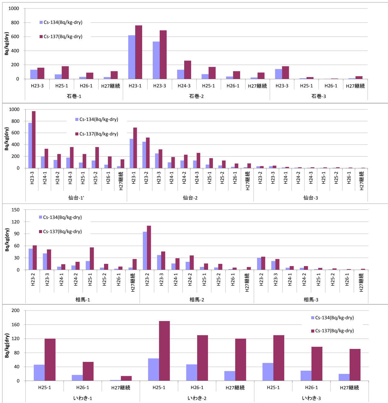
図5 堆積物中セシウム134、137濃度(継続モニタリング調査)
