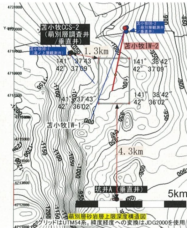
第 3. 2-3 図 萌別層圧入井周辺の圧入した CO 2 の分布予測範囲と、周辺の廃坑井との位置関係
