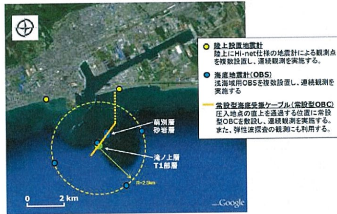
図 2.2-17 微小振動、自然地震観測機概略配置図
