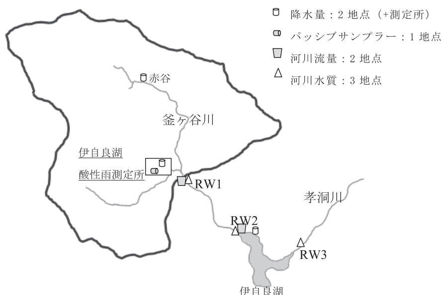
図 2-3 伊自良湖集水域モニタリング装置配置図
