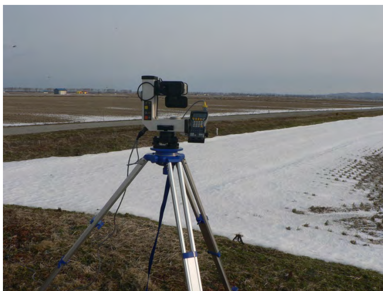
写真 1-2-1-6 飛行高度の測定に用いた高性能レーザー測遠機 (トータルステーション RTS-21HA)
