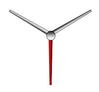
図-10 1 枚のブレードの彩色例 (赤色、根元から先端部彩色)
