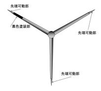
図-11 検証実験におけるブレードの彩色例 (黒色、先端部彩色)
