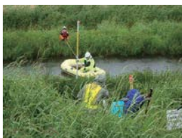
▲堆積土砂量測定状況
