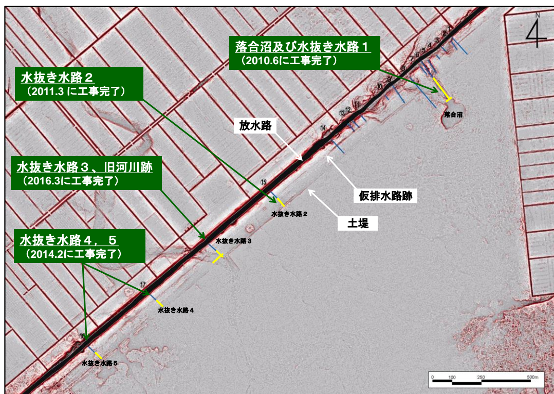
図 4-8 事業の対象とした水抜き水路と対策工実施状況
