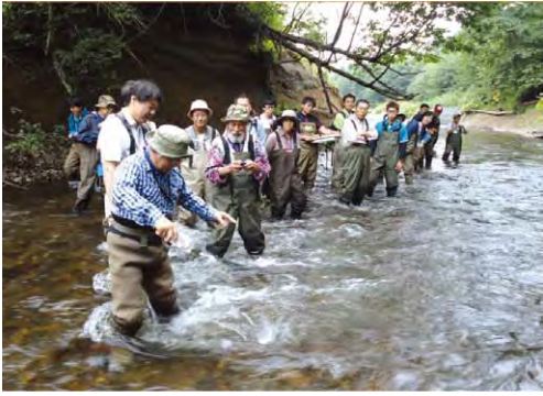
久著呂川中流部での簡易流速測定の実験調査 (北海道釧路建設管理部)
