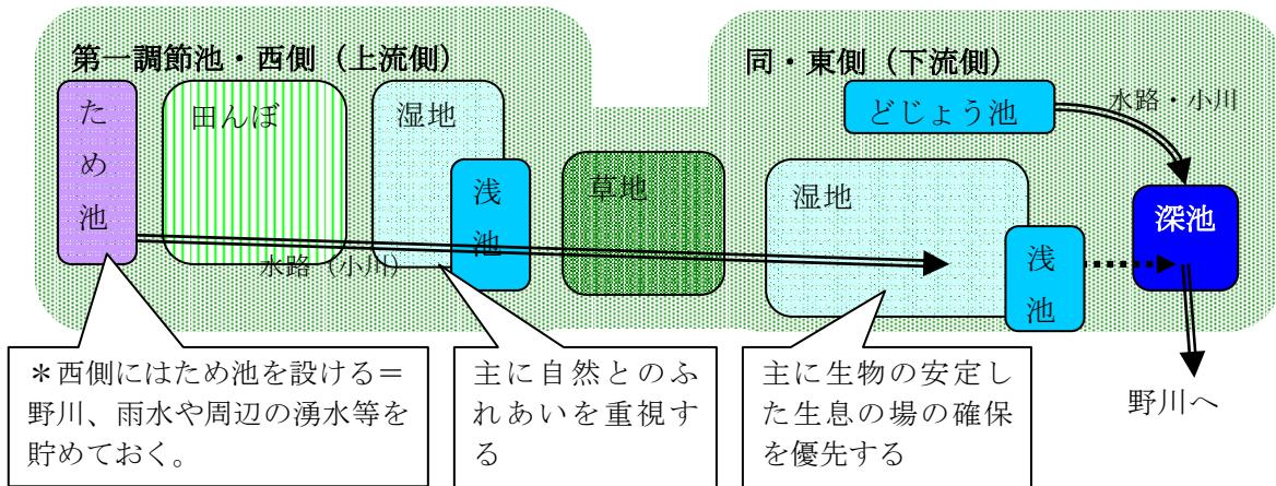
図-2.2.3 第一調節池の施設構成（最終段階）
