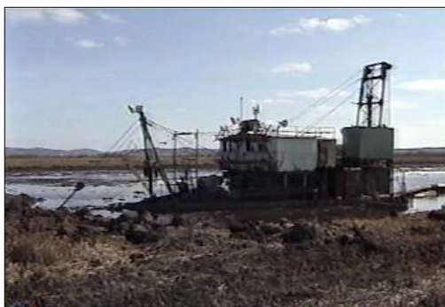
採掘に用いられた浚渫船。 前方にカッターの付いたアームを備え、後方には泥炭採掘水を圧送するホースが見える。
