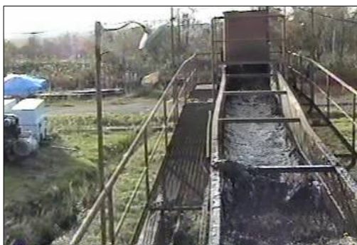
浚渫船からポンプで圧送された泥炭採掘水。 植物繊維を多く含む。
