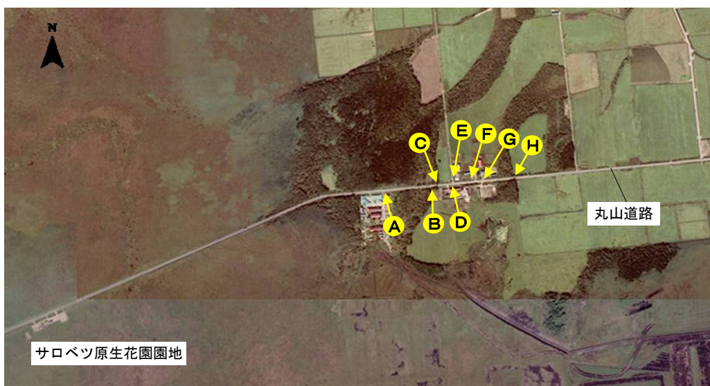
図 4-9 道路側溝への排水流入箇所の分布
