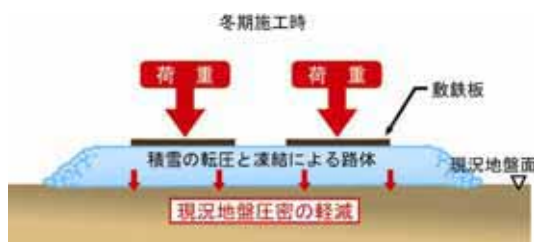
図 4-10 現況地盤圧密の軽減対策例
