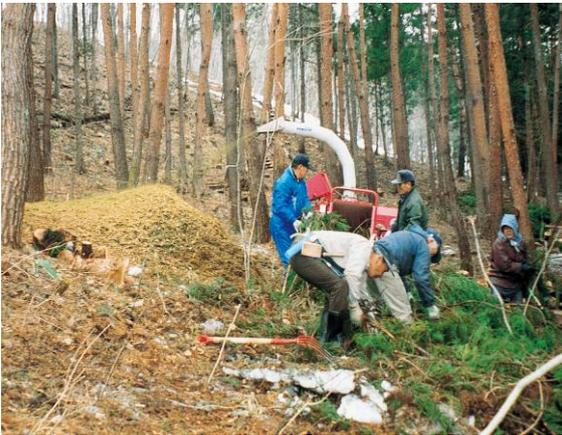
写真3-3 間伐材のチップ化
