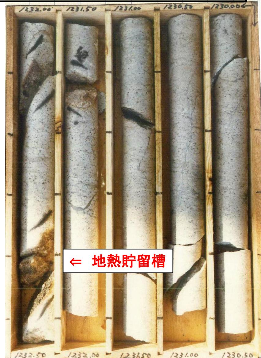
右のボーリングコア写真は、1.2km地下に在る幅1cmの鉱脈を推定して掘り当てたもの。
