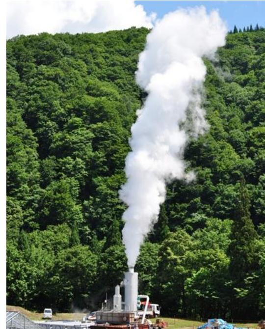
○最近では、気水分離器(セパレータ)を通して乾いた蒸気のみ大気開放されるため、騒音および熱水飛散は軽減。このため、樹木への着氷被害もない。
