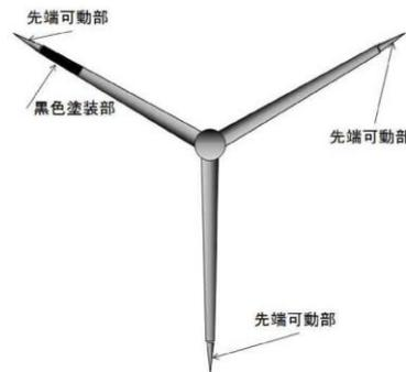
図-58 検証実験におけるブレードの彩色例
