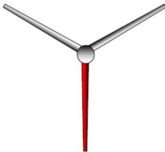
図-57 1枚のブレードの彩色例
