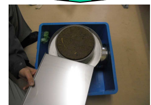
コアスライス状況
