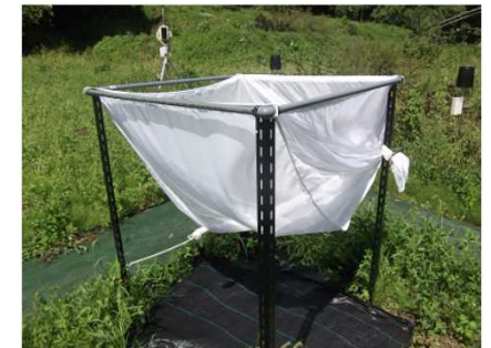
図1 リタートラップの設置状況
