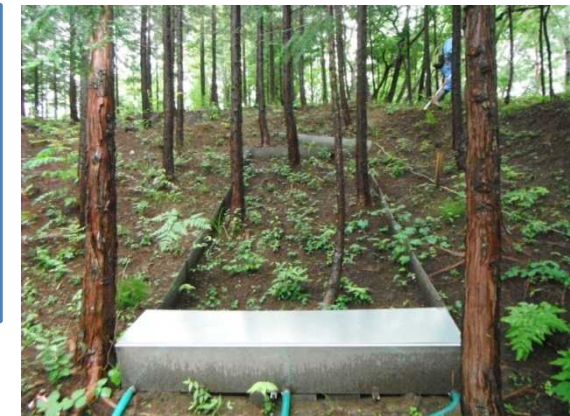
斜面試験枠(幅2m×奥行き5m)
