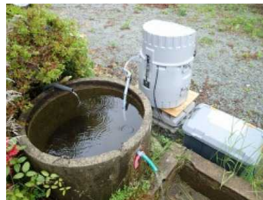
自動採水装置の設置例(飯舘村)
