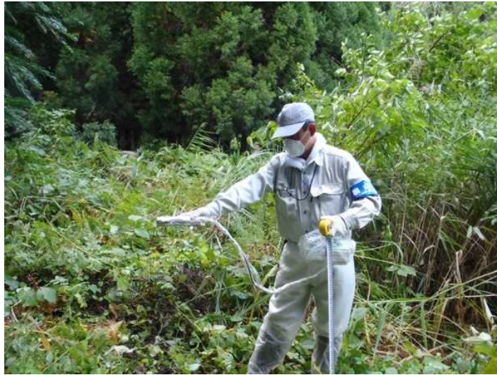
図.6 空間線量率の測定 (例)
