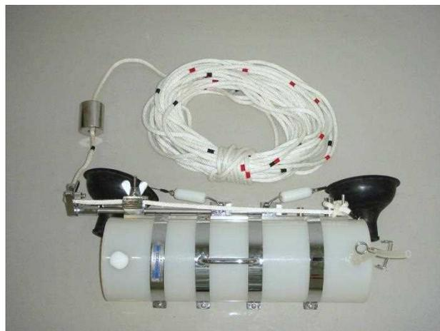
図.7 バンドーン型採水器
