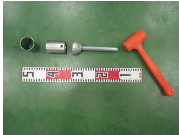
土壌採取用ステンレス管と打ち込み用具
