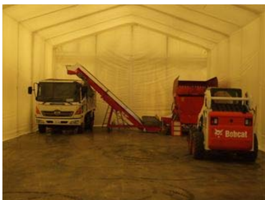
図 4-5 破砕機の屋内設置（例）
