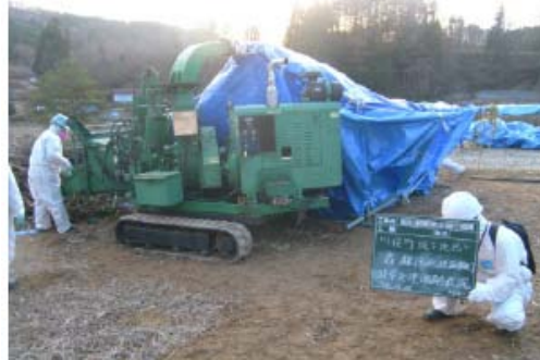
図 2-26 破砕機（チップパー）による減容化（例）
