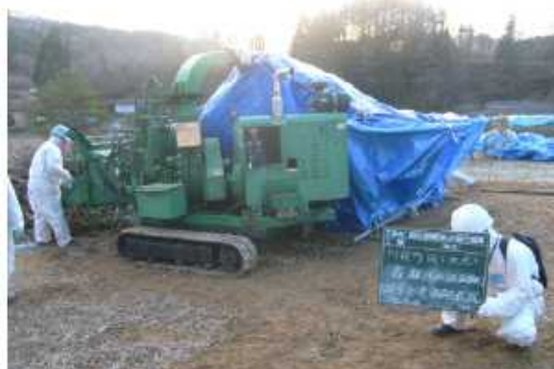
図 2-20 破碎機（チップパー）による減容化（例）
