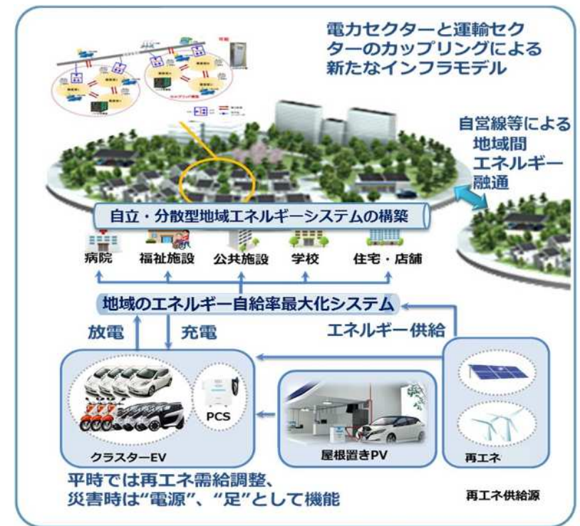
地域の自立・分散型エネルギーシステム
