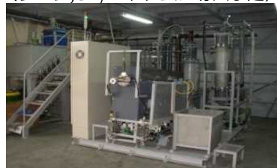
専焼型破壊設備 （フロンJCM/ベトナムに導入予定）
