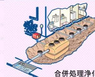
合併処理浄化槽
