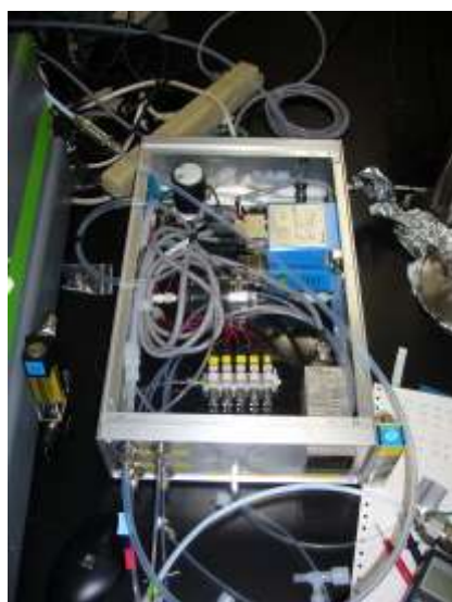
図7 船舶観測室に設置したキャビティリングダウン式分光計 (右) とガスインジェクションユニット (左)
