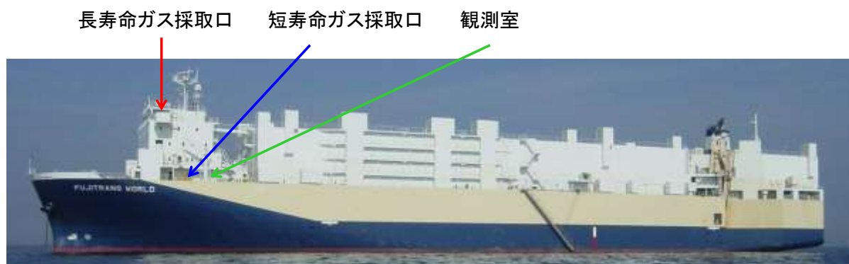
図2 FUJITRANS WORLD 号の外観と、ガス採取口および観測室の場所
