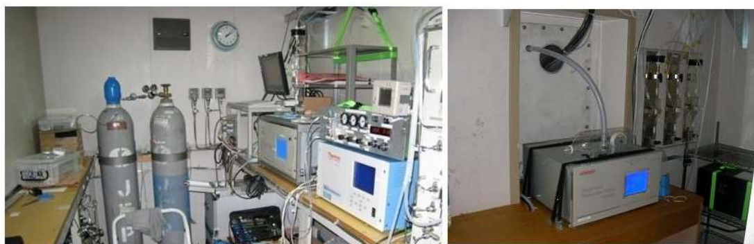
図6 連続測定装置の写真（左：オゾン、一酸化炭素； 右：ブラックカーボン）
