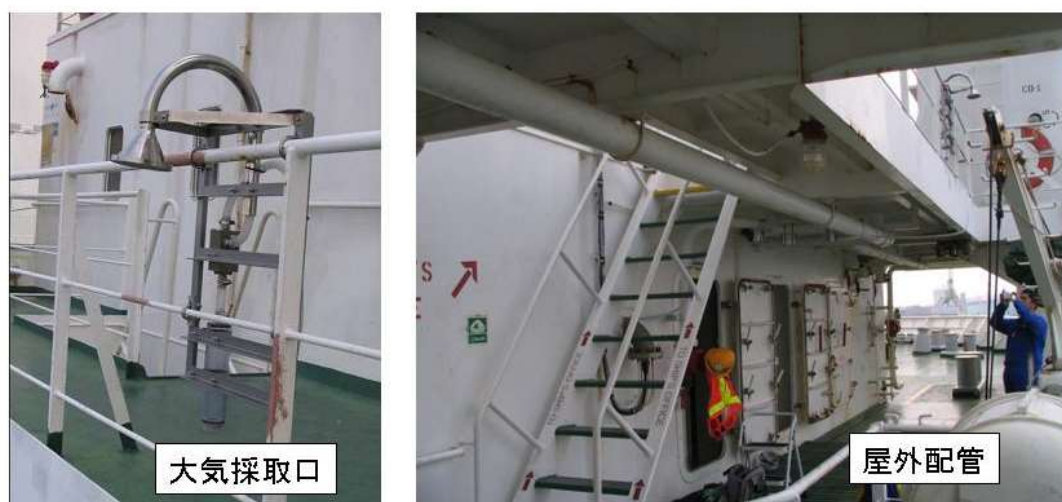
図5 連続測定器の大気採取口と屋外配管
