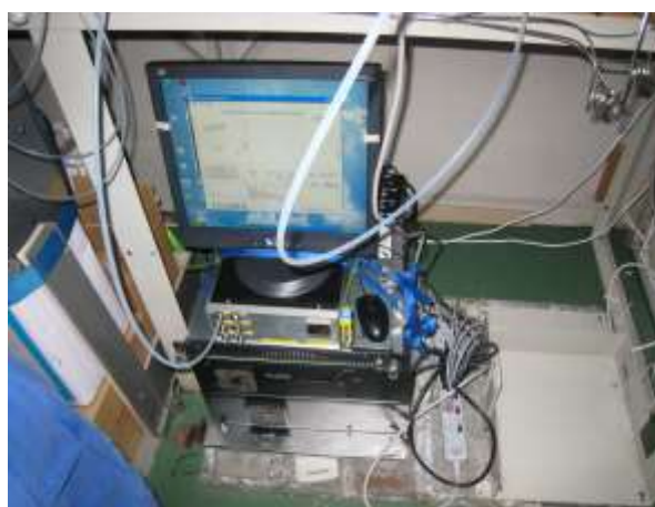
図7 船舶観測室に設置したキャビティリングダウン式分光計 (右) とガスインジェクションユニット (左)
