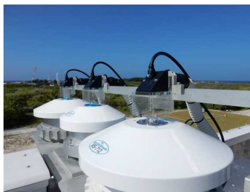
図6 防塩装置がガラスドームを清掃している様
