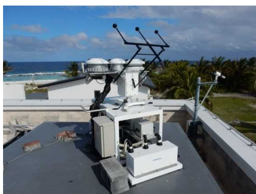
図4 南鳥島に設置した防塩機能付き精密分光日射観測装置
