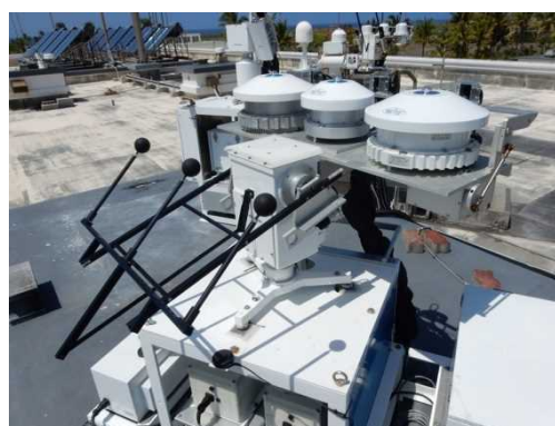
図4 南鳥島に設置した防塩機能付き精密分光日射観測装置
