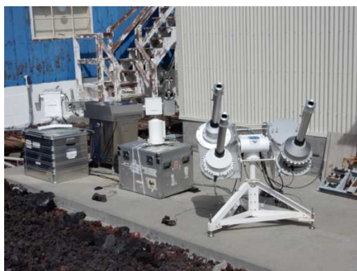
図7 マウナ・ロア観測所での校正観測の様子 (奥：分光型直達日射計、中央：スカイラジオメータ、手前：コリメーションチューブを取り付けた分光型全天日射計 (MS-711N, MS-712, MS-713) )
