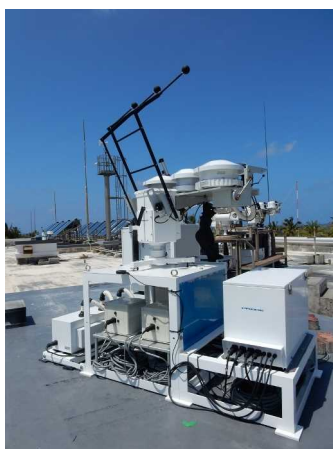
図4 南鳥島に設置した防塩機能付き精密分光日射観測装置（右）と防塩装置によるドーム清掃（左）
