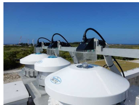
図4 南鳥島に設置した防塩機能付き精密分光日射観測装置（右）と防塩装置によるドーム清掃（左）
