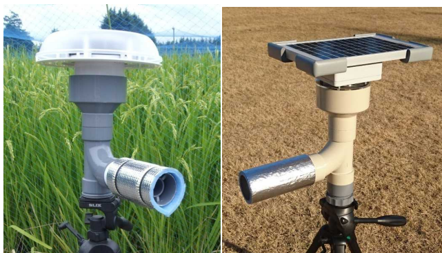
図3 MINCER 第1世代機（左）と開発された第2世代機（右）
