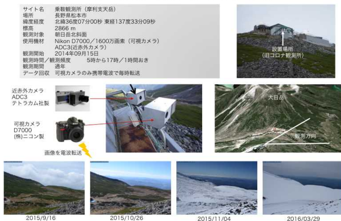
図 1 4 乗鞍岳の可視カメラと赤外線カメラによる生態系長期モニタリングシステム。
