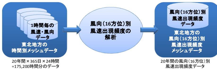
図 2-70 東北地方における風向（16 方位）別の風速出現頻度データ作成フロー
