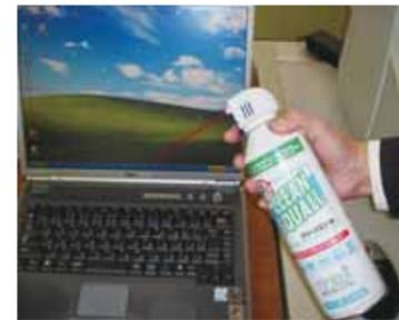
ダストブローワーは、高圧のガスを噴射し、ほこりなどの粉塵除去、静電気除去、冷却などの目的で、事務用機械（コンピューターやその周辺機器・OA 機器等）、製造工場・研究所等の精密機器（電子機器・光学機器等）、銀行やコンビニエンスストア等の ATM、駅の自動改札機のメンテナンス等に幅広く利用されています。ダストブローワーは、コンピューターなどが普及するにつれて大幅に需要が増大しており、近年では毎年 600 万台程度が販売されています。
