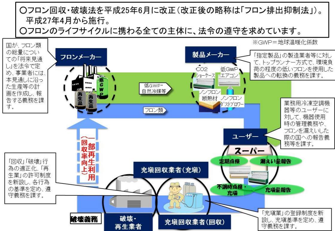
図2 整備時のフロン類の流れ
