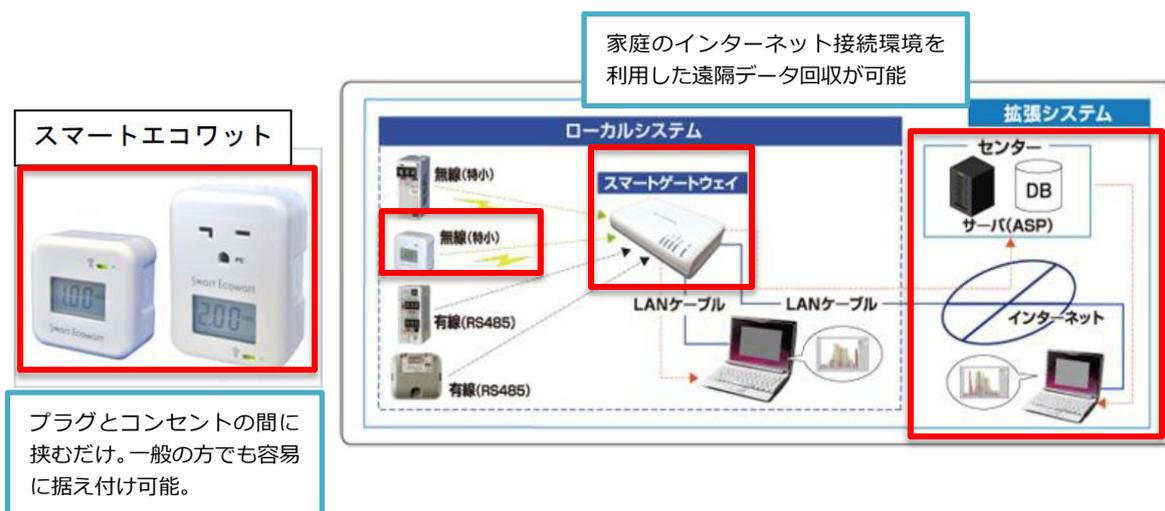
図 5.1.2 コンセントでの個別計測用システム
