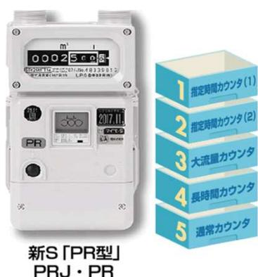
新型 LP ガス用マイコンメーターマイコン S「PR 型」(ハイブリッドカウンター) は 5 つのカウンタがあり、時間帯別・需要帯別にガス使用量を分けてはかります。分けてはかったガス使用量に特別料金を適用させることで、新料金メニューの構築が可能となります。
