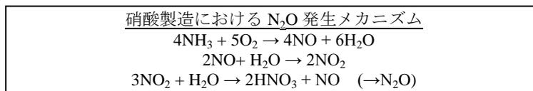
日本国内の硝酸製造においては、オストワルド法の化学反応をベースとした新ファウザー法（中圧）、ケミコ式（高圧）などが主流となっている。なお、N<sub>2</sub>O分解については一部触媒を用いた装置を稼働させている。
